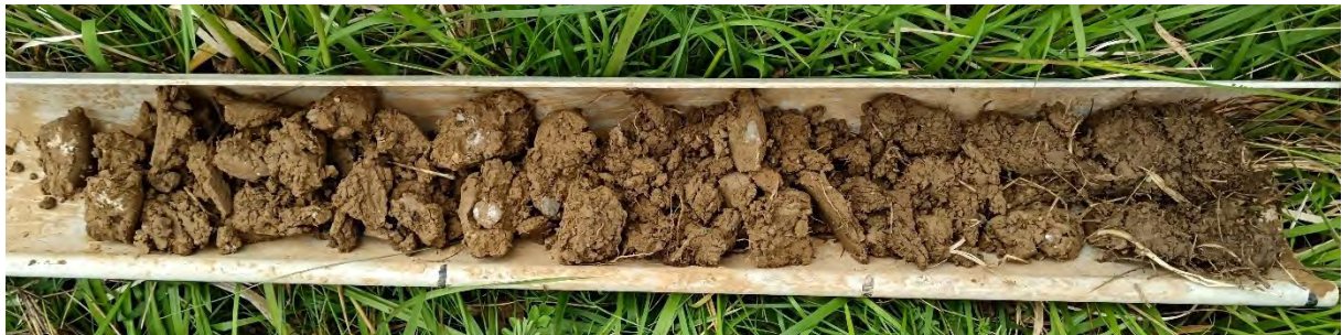
Exemple d'un sondage pédologique (ici S4) (Source : IAD) Pas de présence de pseudogley, sol caillouteux, arrêt à 75cm sur calcaires
