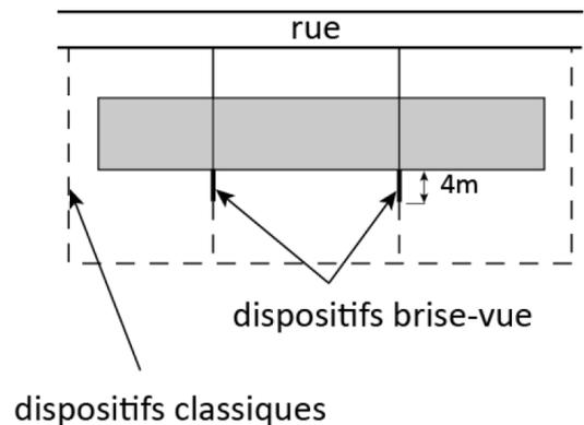
En cas de limite avec vis-à-vis, la réglementation des clôtures sur rue sera appliquée.
